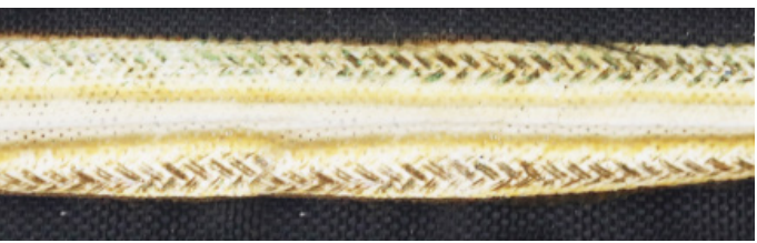
发热电缆在 245°C 持续 5 分钟：PA66 已经熔化，并展现了 PTFE 的保护层，其没有变差。发热线的保护经常是通过 PTFE 和硅胶绝缘来完成的。
