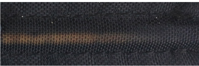
发热电缆在 220°C 持续 1 小时：PA66 开始变色
