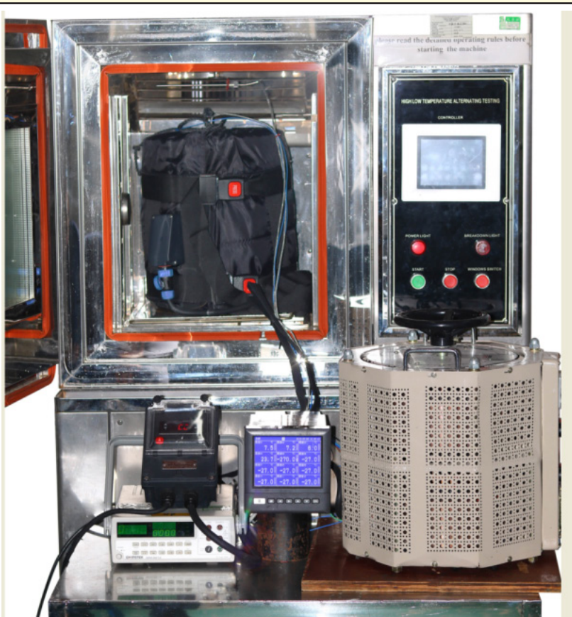
布袋加热器正在负温度进行的气候测试
