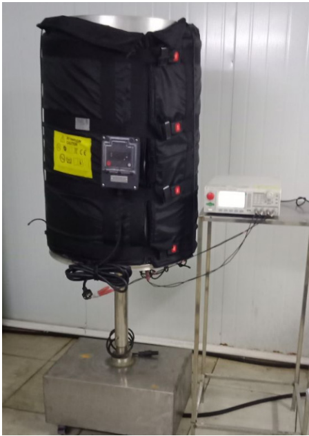
IPx6 测试后的绝缘电阻测量
