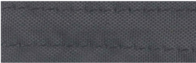
发热电缆在 120°C 持续 96 小时：没变色，绝缘没熔化，性能没发生变化
