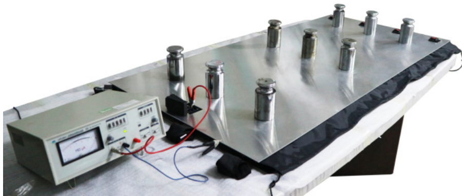
用于测量绝缘电阻的装置。 测量的数值经常大于 0.1Gohm
