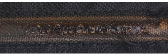
发热电缆在 235°C 持续 1 小时：PA66 开始熔化
