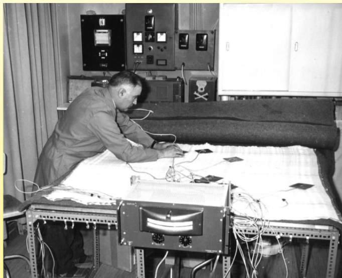
测量加热毛毯的表面温度 (约 1960 年, Vedette, Ultimheat 博物馆)
