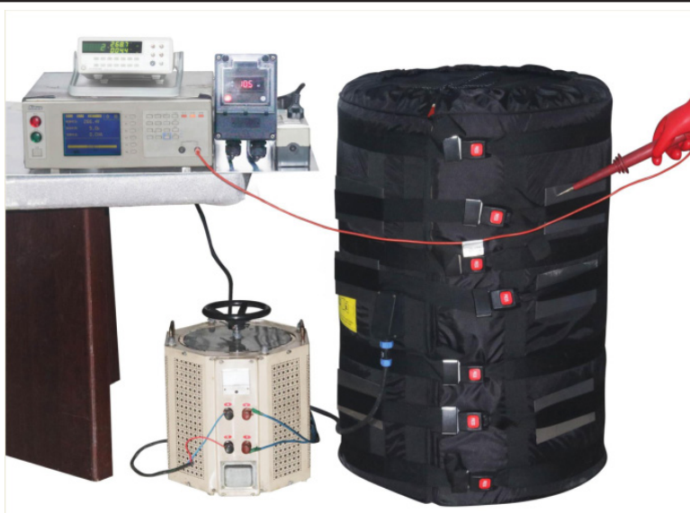
在热条件下总电流泄漏的测量设备
